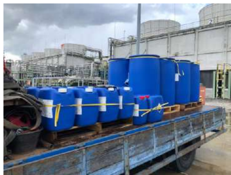
ภาพที่ 2.2-34 รถขนส่งสารเคมีที่มีอุปกรณ์รัดถัง
